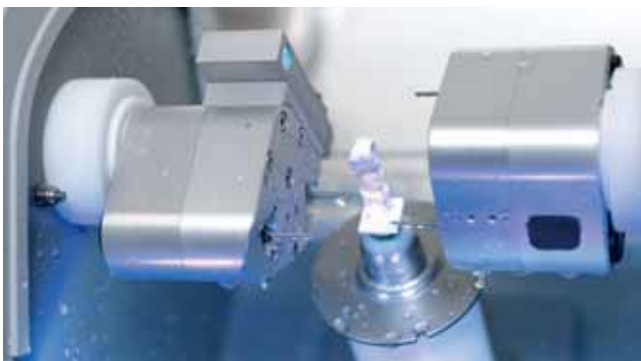
Abbildung 2 Zirkoniumdioxid-Brückengerüst nach Beendigung des Formschleifprozesses in der Schleifkammer einer dentalen Nass-Formschleifmaschine für keramische Restaurationen (hier CEREC MC XL/Sirona). Das Gerüst bleibt am Ende der Bearbeitung mit dem Restblock samt Blockhalter durch einen schmalen Steg verbunden. Der Zahntechniker nimmt das Ganze aus der Schleifkammer und trennt das Gerüst manuell vom Restblock ab.
